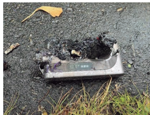
出火場所から発見された焼けた充電式電池
