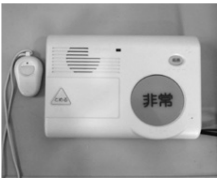
緊急通報機「あんしんSV」(右)とペンダント型ワイヤレス通信機
