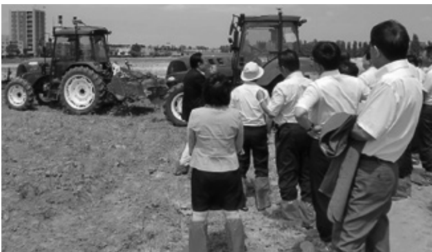
無人走行による追従システムを搭載しており、複数の作業を一人で安全に行うことができる。
