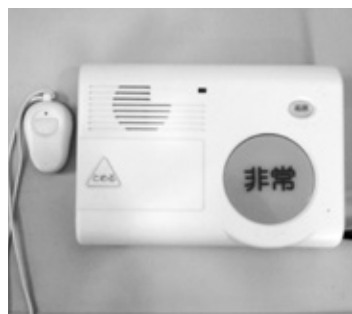
緊急通報装置本体とペンダント
