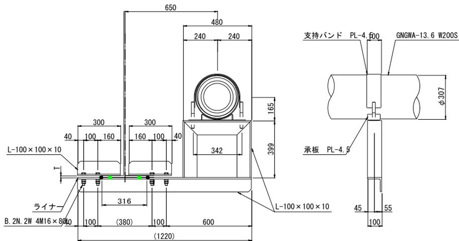
配管詳細図（変更後）
