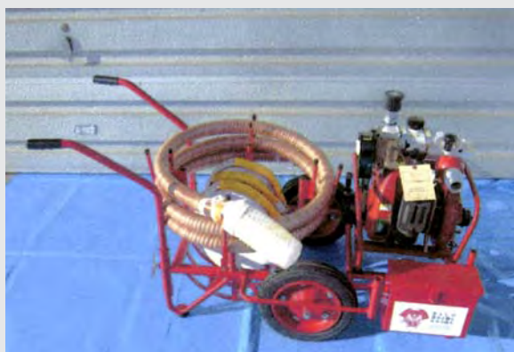
▲小型消防ポンプ
