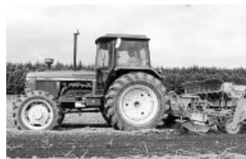
工夫が評価された作業機の連結、畑を整地する作業機の後ろに種まき機械を連結して2回の作業を1回で済ませている
