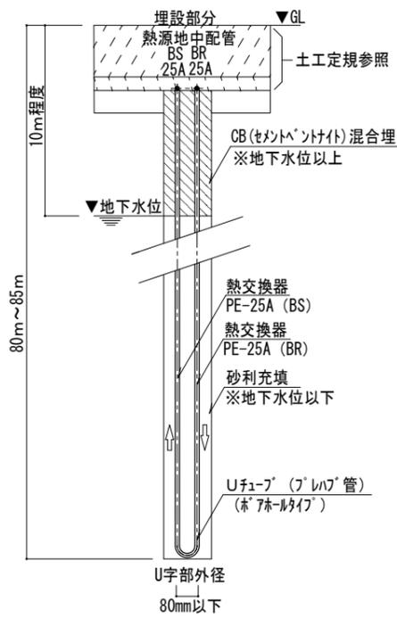
地中熱交換器断面図 NO SCALE
