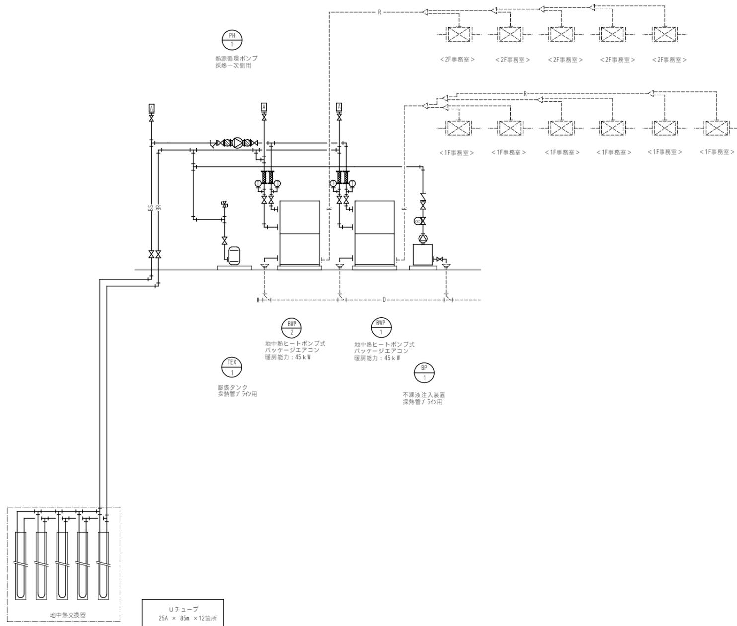
空調系統（事務室）地中熱設備系統図
