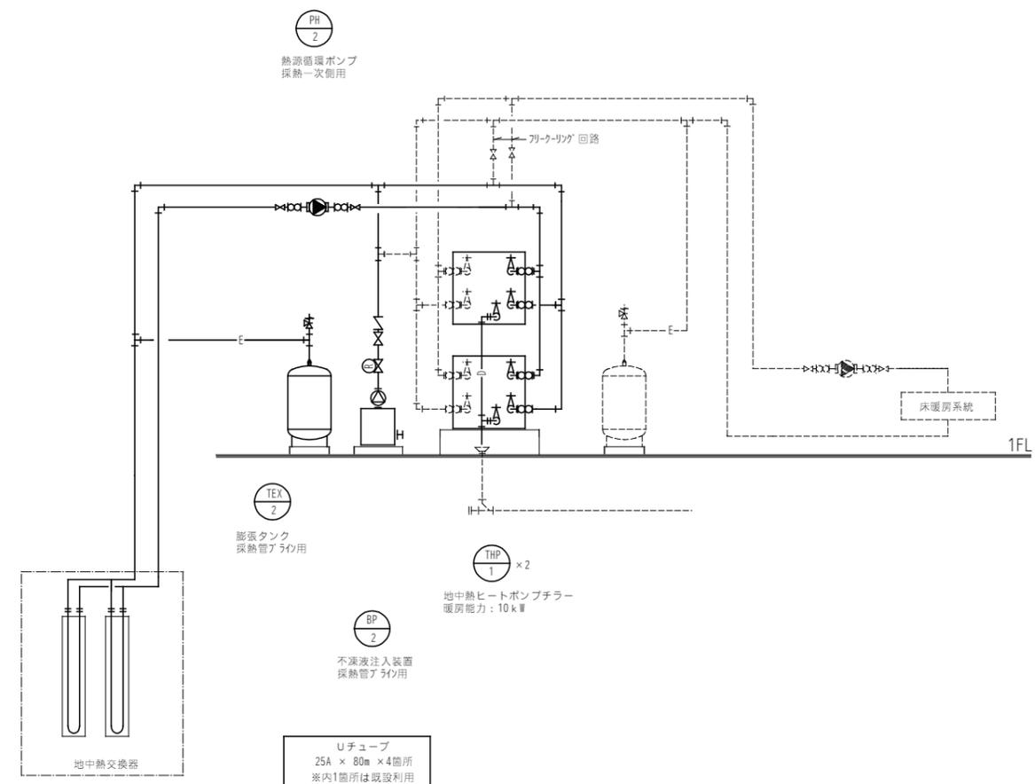
床暖系統（町民ロビー）地中熱設備系統図
