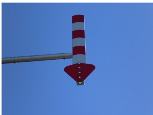
緑色に発光する視線誘導柱は悪天候時でも車道と歩道の境界を照らすことができる。
